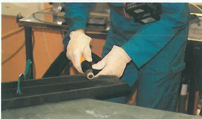
Slipning med slipcylinder.
