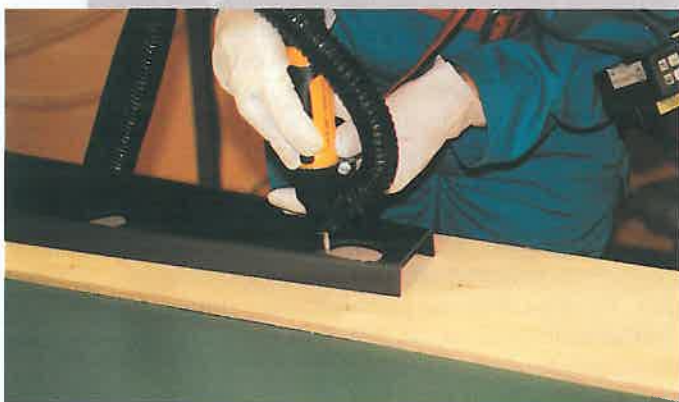
Slipning med slipstift.
