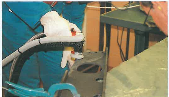
Slipning med sliprondell.
